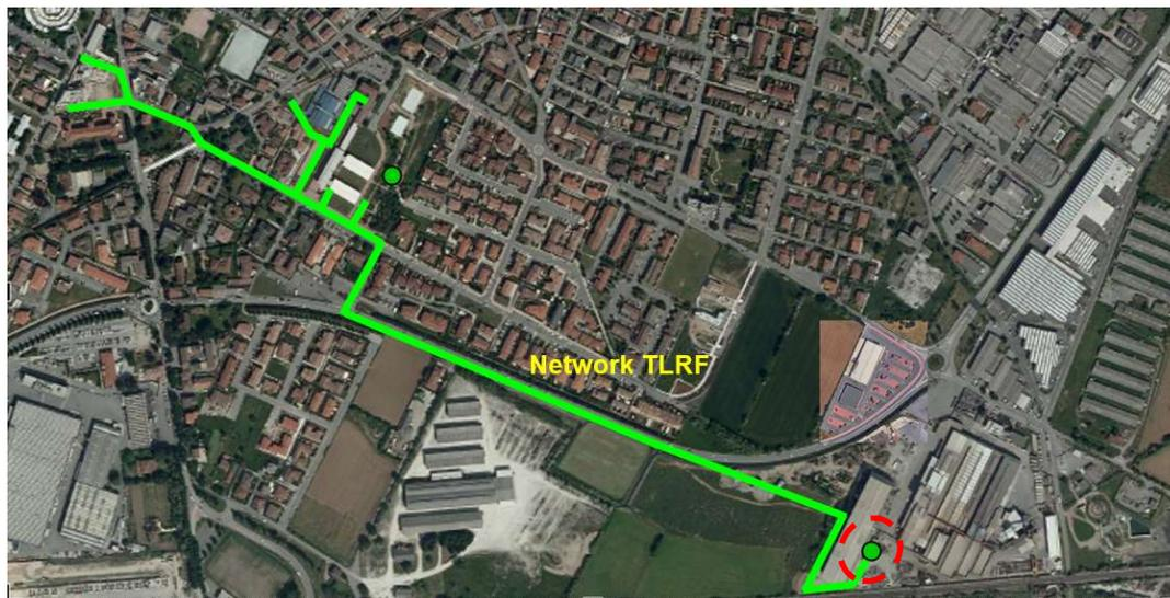
La sottostazione recupera circa 1 MW di energia termica dalle torri di raffreddamento a 25 ° C
